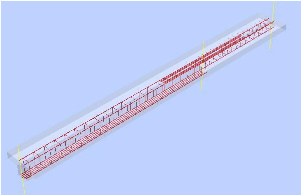
Die Bewehrung wird in DLT als 3D-Bewehrung erzeugt
