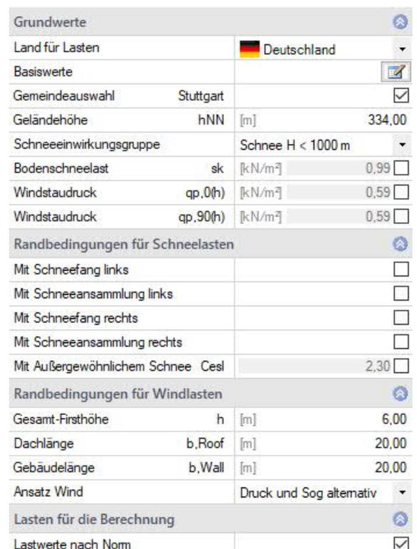
**Windbereich** Beim Grat/Kehlsparren kann optional gewählt werden, welcher Windbereich für die gemittelte Windlast am Haupt/Nebendach zugrunde gelegt werden soll. Ansonsten nimmt das Programm automatisch den Bereich mit dem größten Winddruck.
