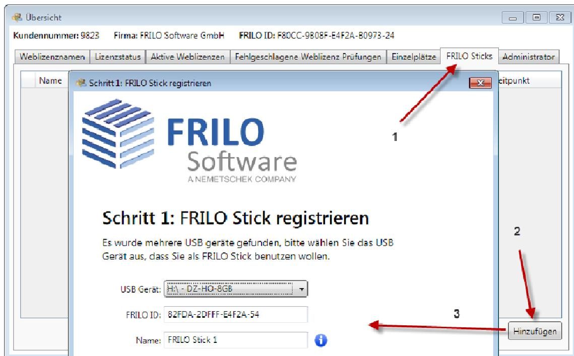
Im ersten Schritt wird ein neuer Memorystick analysiert, die entsprechende Kennung ermittelt und in die FRILO-Lizenzdatenbank eingetragen. Danach kann man einzelne oder auch alle Programme dem neu definierten FRILO-Stick zuordnen.
