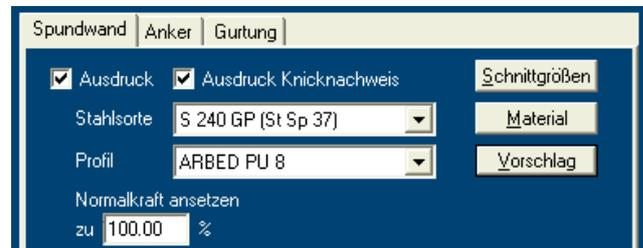
Für Sonderfälle kann über die Taste „Material“ die Streckgrenze des Stahls sowie die angesetzten Sicherheitsbeiwerte (siehe unten) verändert werden:
