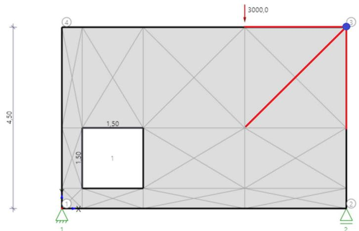
Wird für die „Vernetzungsdichte der Stäbe“ der Wert 2 angenommen, so werden zusätzlich die Nachbarknoten des Nachbarknotens durch Stäbe verbunden (Abb. rechts).
