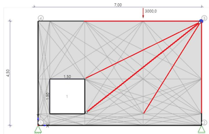
Ein Wert von 3 bedeutet, dass zusätzlich die Nachbarknoten zweiten Grades des Nachbarknotens durch Stäbe verbunden werden.
