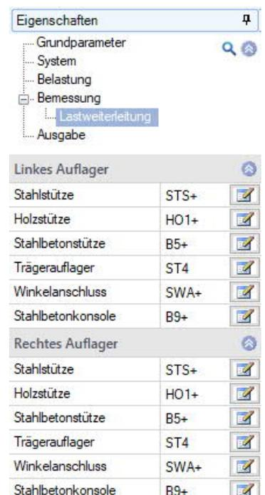
Das Stützensystem wird in BTII+ durch einen Systemabschnitt dargestellt. Die Lagerbedingungen entsprechen dem statischen System des Trägers einschließlich der seitlichen Halterung.
