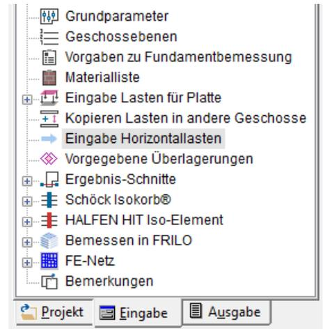
Es können sowohl Horizontallasten von Hand eingegeben, als auch Windlasten und Lasten aus Schiefstellung und Erdbeben vom Programm generiert werden.
