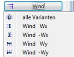
Alle Varianten: Bei dieser Option werden mehrere Lastfälle mit gleichen Windlastparametern für die entsprechende Windrichtung angelegt. Bei Bedarf können diese Lastfälle danach einzeln mit individuellen Windlastparametern über die Funktion „Wind generieren“ neu belegt werden.
