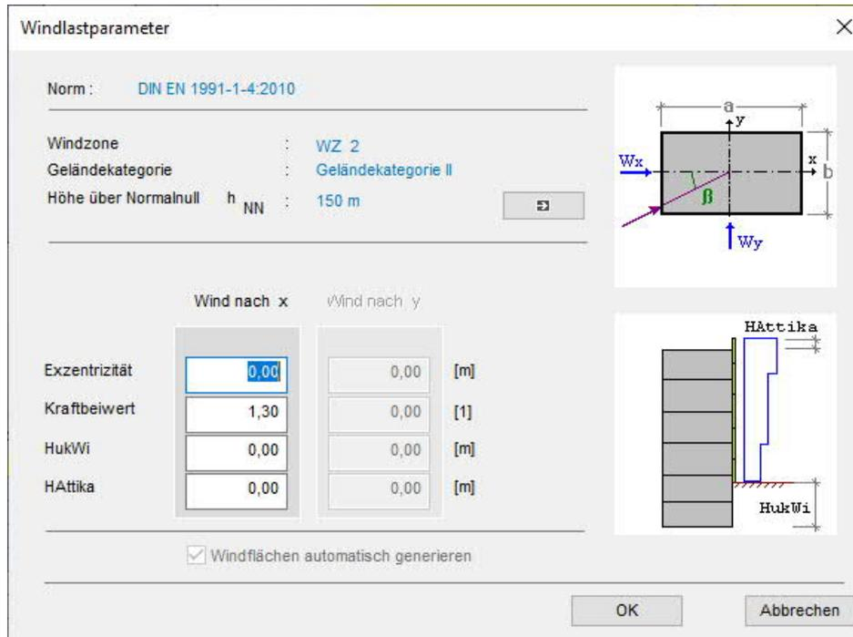
Die Windlasten werden anhand der bereits eingegebenen Geometrie und der hier zu definierenden Randbedingungen (Wind nach x / y) generiert.
