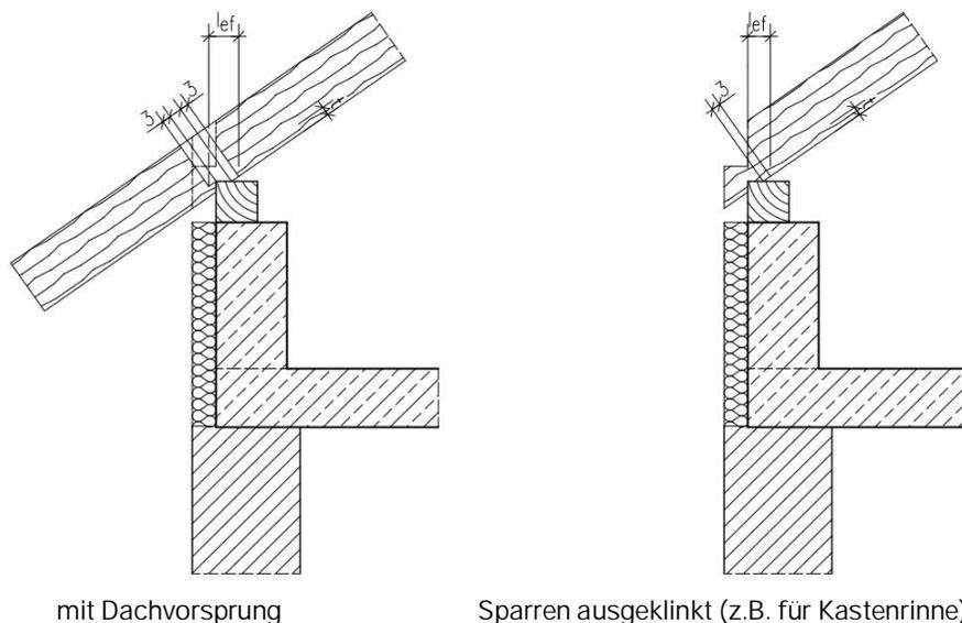
*Hinweis:* Das ausgeklinkte Sparrenauflager kann so wie abgebildet nicht eingegeben werden, die Zeichnung dient lediglich zur Verdeutlichung der Situation eines reduzierten Sparrenüberstandes.
