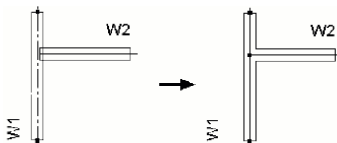
Bild 3: Außenkante - Punkt - Verbindung
